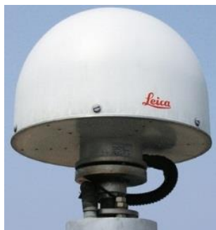
Figuur 2 Leica AR25 GPS-antenne
