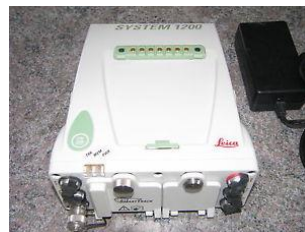
Figuur 3: Leica 1200 GPS-ontvanger
